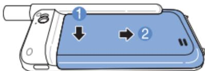
Вставьте батарею, начиная с верхнего конца. После установки батареи закройте крышку батарейного отсека.
