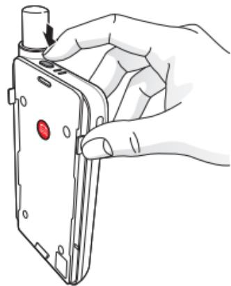
Чтобы выключить устройство, нажмите и удерживайте кнопку питания на устройстве в течение 2 секунд, пока не загорят красные светодиоды и не прозвучит звуковой сигнал.
