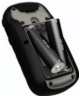
3. Установите на место крышку отсека для элементов питания и поверните D-образное кольцо по часовой стрелке.
